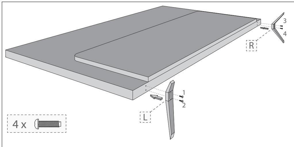
**Русский:** Чтобы собрать подставку к телевизору, Вам понадобится крестовая отвертка. Чтобы избежать повреждения экрана телевизора во время сборки убедитесь, что телевизор размещен на мягкой поверхности ЖК-экраном вниз. Площадь поверхности должна превышать площадь экрана телевизора
